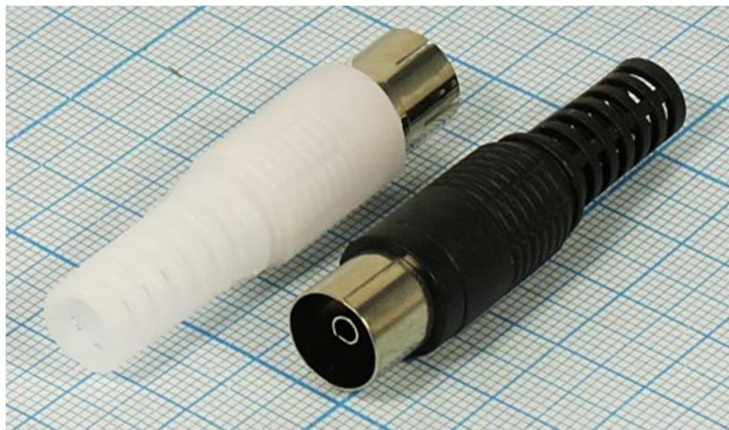
**Разъем имеет никелированный центральный контакт и никелированный корпус. Материал изолятора допускает применение фторопласта, полиэтилена, полистирола. Разъем предназначен для быстрого монтажа без применения пайки. Центральная сигнальная жила кабеля крепится винтом, оплетка кабеля, экран, обжимается. Возможно применение кабелей с диаметром внешней оболочки до 6 мм.**
