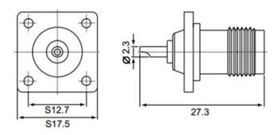
TNC миниатюрный высокочастотный разъем - это резьбовая версия разъема BNC. Имеет волновое сопротивление 50 Ом и улучшенные шумовые характеристики при вибрации, чем BNC серия. Диапазон рабочих частот до 11 ГГц.
