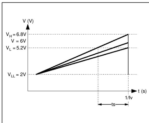
$$\frac{V_H - V_L}{t_s} = \frac{V_H - V_{LL}}{1/f_v}$$
