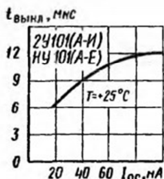
Зависимость времени выключения от тока
