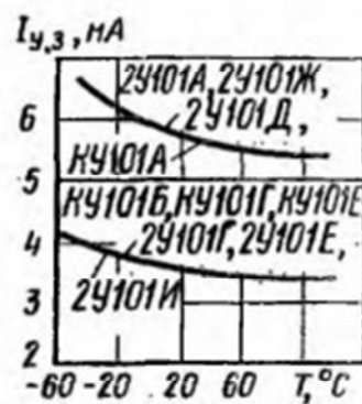
Зависимости отпирающего постоянного тока управления от температуры
