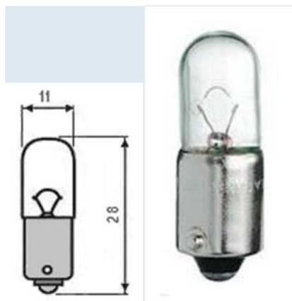
Миниатюрная лампа накаливания МН-26.0-0.12 применяется для освещения и подсветки шкал радиоэлектронных приборов, сигнализации, в карманных, портативных и батарейных фонарях, в велосипедных фарах и т.д.
