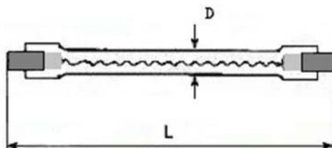
Лампы предназначены для работы в светильниках наружного и внутреннего освещения в сетях переменного тока частоты 50 Гц. Рабочее напряжение 220 вольт, мощность 150 вт. Длина  $L = 80\text{мм}$ , диаметр  $D = 8\text{мм}$ .
