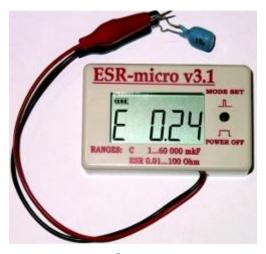
"ESRmicro v3.1 предназна чен для измерени я емкости и ESR (Equivalen t Series Resistance ) электроли тических
