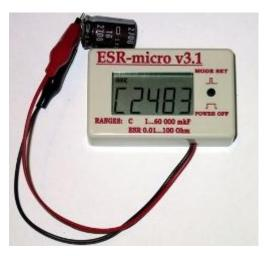
конденсаторов без демонтажа их из печатной платы, что в значительной степени уменьшает время поиска неисправности, повышает качественные показатели ремонта аппаратуры.
