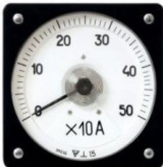
Амперметр М1611 - круглошкальный щитовой прибор, используемый для измерения тока в сетях постоянного тока и пульсирующего тока частотой 100 Гц. Пылезащищенные.
